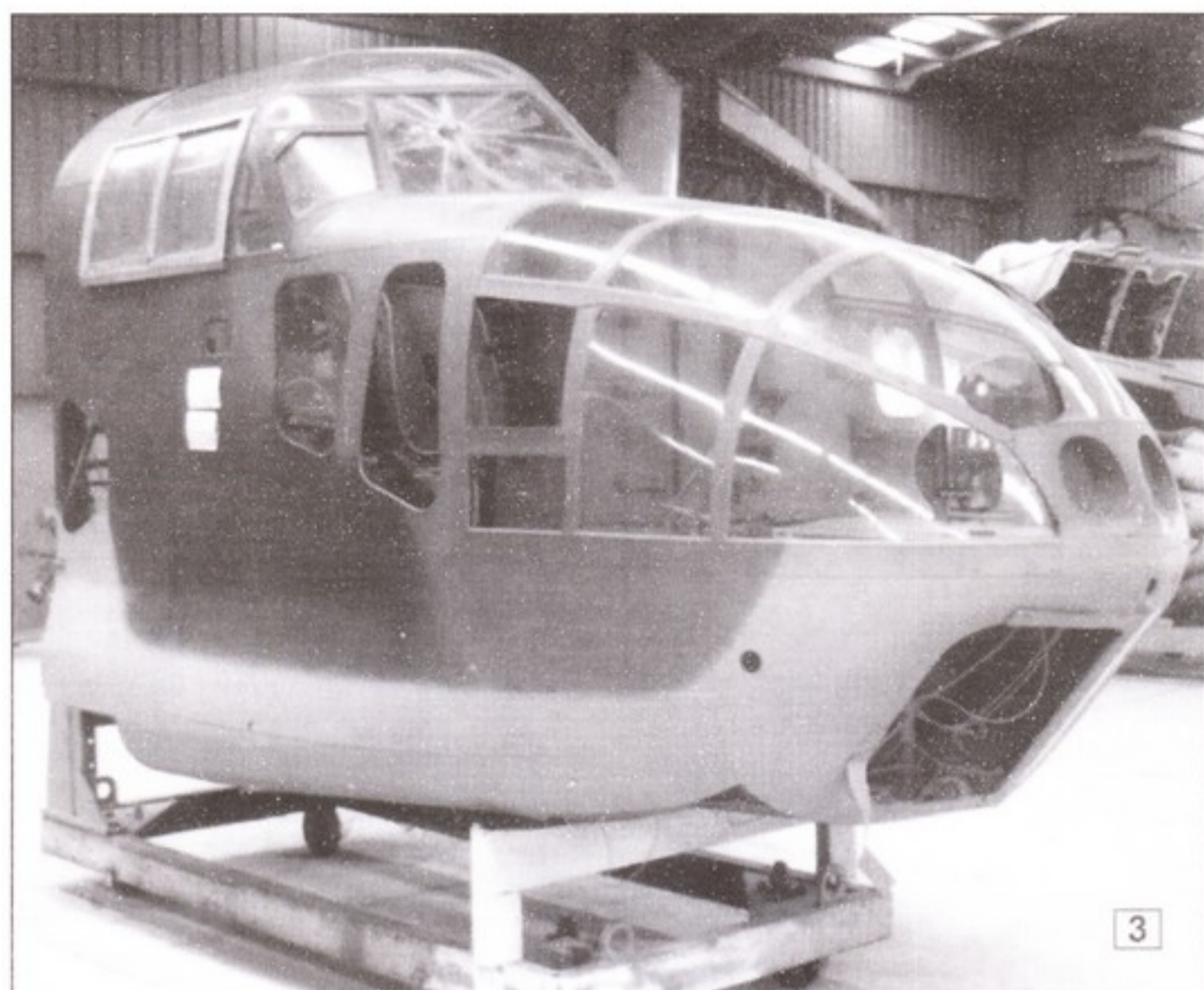
3. Носовая часть А9-703. Обратите внимание на поврежденный ветровой козырек.
