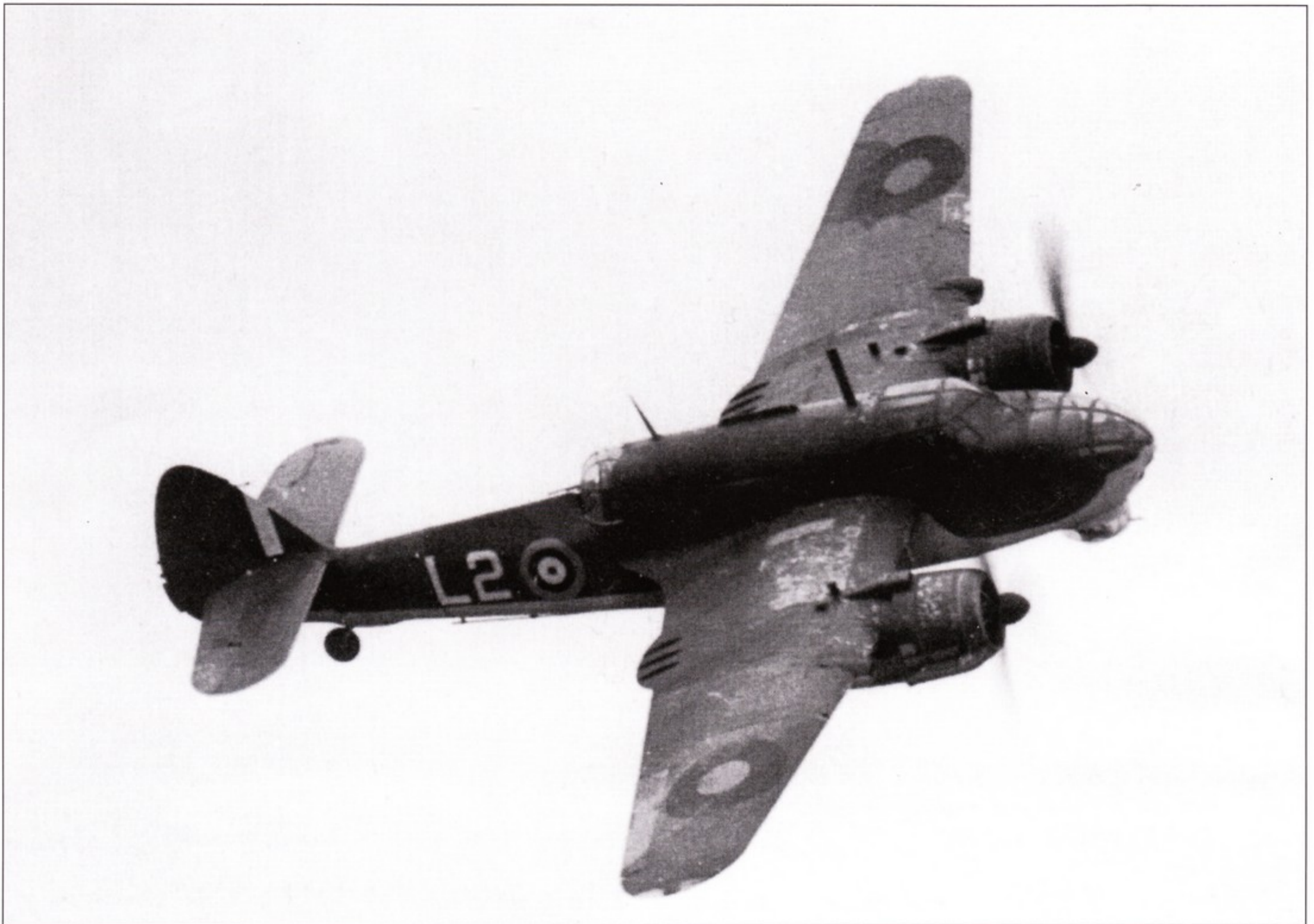
«Бомбардировщик» Mk.IA X8931 L2 из 3-го ОТУ. Позднее машина служила в 5-м ОУТ и была списана 31 января 1946 года. Обратите внимание на подфюзеляжную турель - пулемет развернут стволom вперед.
