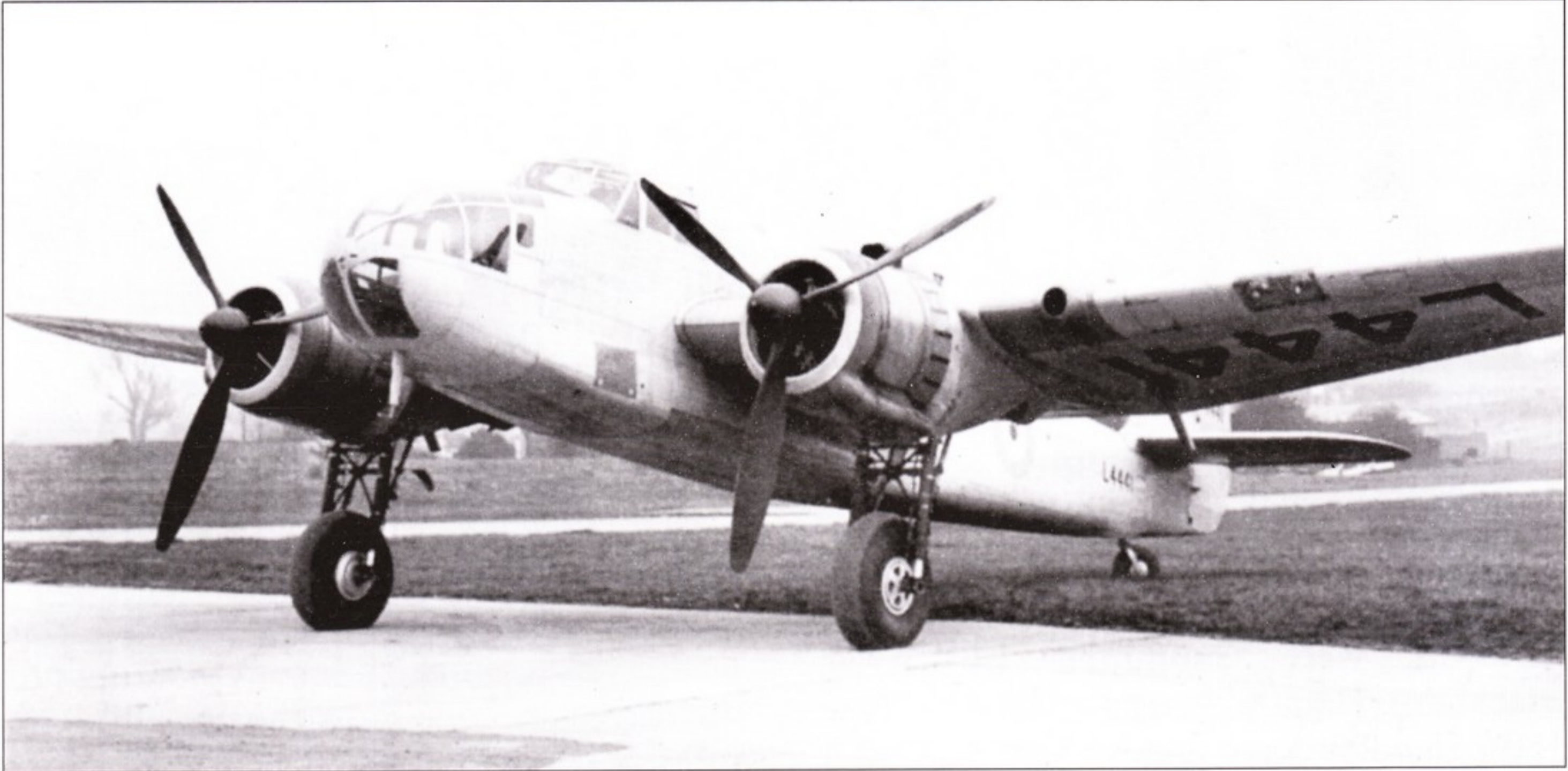
Вскоре после начала испытаний L4441 с него были сняты большие створки ниш шасси. Обратите внимание на новые створки системы охлаждения по периметру задней кромки капота и серийные номера на нижней поверхности крыла.
