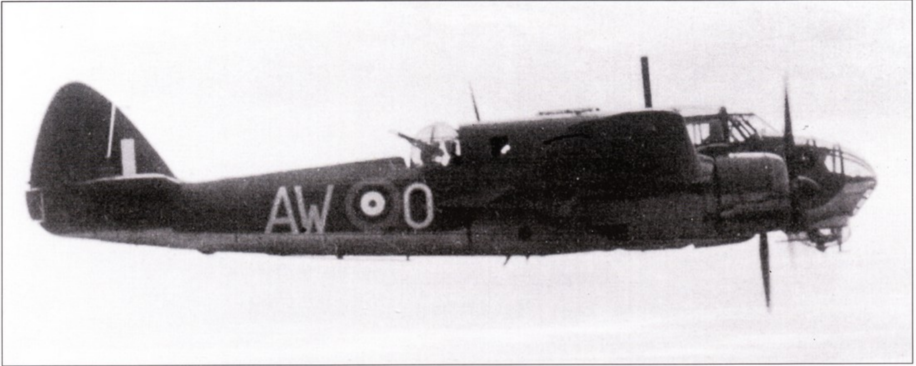
«Бофорт» AW243 AW-O пропал без вести у побережья Норвегии 11 декабря 1941 года, вскоре после того, как был сделан этот снимок. Обратите внимание на турели и большое количество антенн на фюзеляже.
