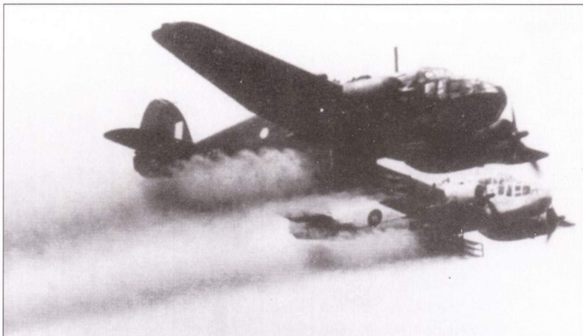
Австралийские «Бомфорты» Mk.IX, A9-728 и A9-738, во время испытаний по опрыскиванию ДДТ, проводившихся в начале 1947 года. В то время эти машины принадлежали испытательному подразделению.
